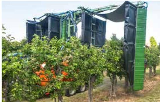
Das Tunnelsprühgerät mit Recyclingeinrichtung und 90 % Abdriftminderung führt die überschüssigen Pflanzenschutzmittel im Apfelanbau in den Gerätekreislauf zurück.
