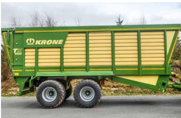
Seitliche Kenntlichmachung mit gelben Rückstrahlern (Vorschrift). Die Kontrastmarkierung mit gelben retroreflektierenden Streifen erhöht die Verkehrssicherheit (Empfehlung).
