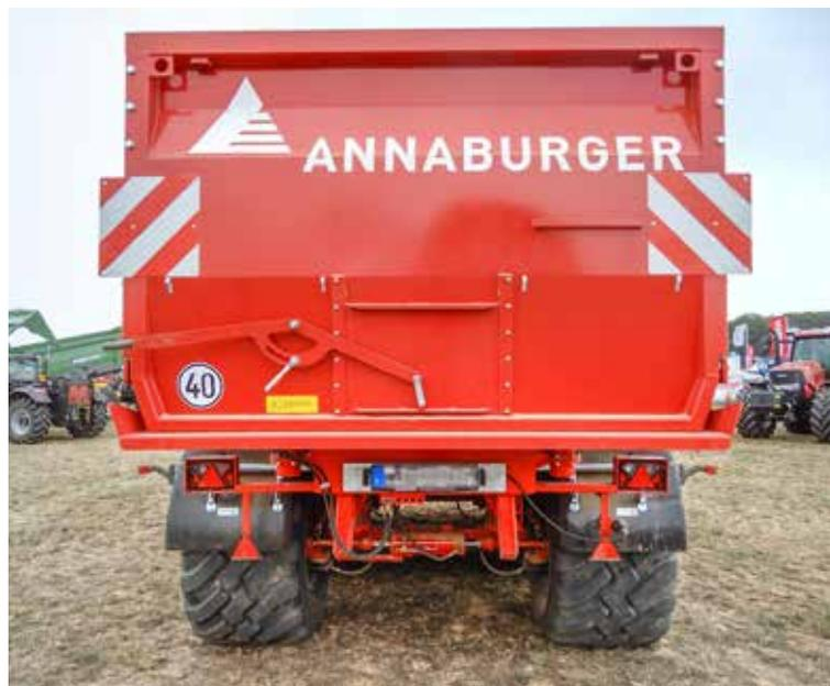
Sind lof Anhänger mit Breitreifen ausgestattet, dürfen sie bis zu 3 m breit sein. Ab 2,75 m und bei Anhängern mit EU-Typgenehmigung ab 2,55 m ist eine Kenntlichmachung mit Warntafeln vorgeschrieben.
