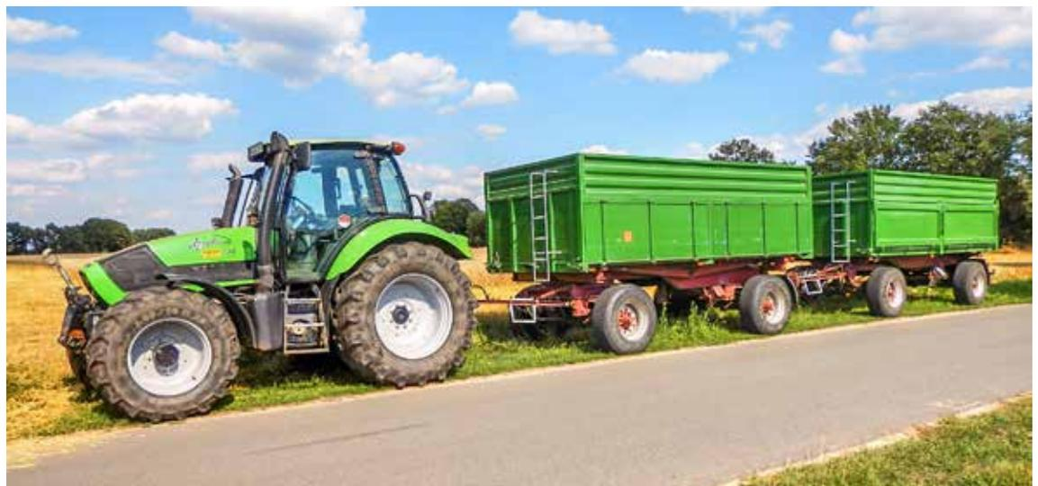
Der Schlepperzug darf maximal 18,75 m lang und 40 t schwer sein. Dabei sind die zulässigen Gesamtgewichte der Einzelfahrzeuge zu berücksichtigen.
