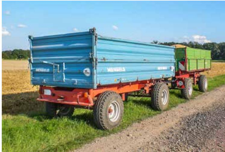
Auflaufgebremste Anhänger dürfen im Zug nicht schneller als 25 km/h gefahren werden. Sie müssen beide mit „25“-Geschwindigkeitsschildern gekennzeichnet sein.
