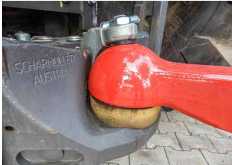
Die starre Kugelkopfkupplung kann in der Regel 4 t Stützlast aufnehmen.
