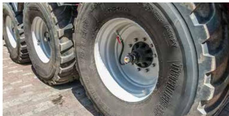
Reifendruckregelanlagen reduzieren Bodenverdichtungen.
