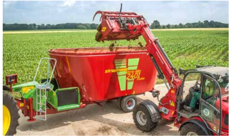
Ob ein Futtermischwagen in Serienausstattung ausreichend ist oder zum Beispiel ein Schaltgetriebe oder Förderband haben sollte, hängt vom Einsatzbereich ab.
