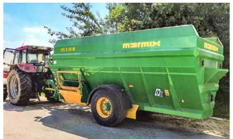
Der Futteraustrag kann mit einem Schieber, Förderkette oder Förderband erfolgen.
