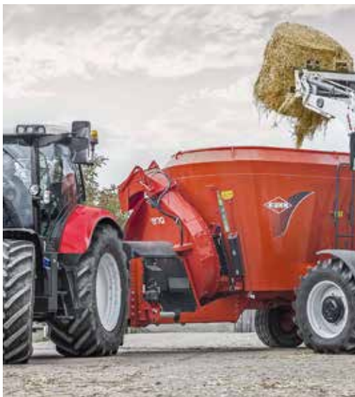
Mit einem am Futtermischwagen angebautes Strohgebläse können auch Strohballen aufgelöst und eingestreut werden.
