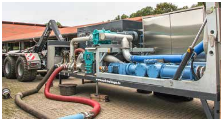
Der Großseparator der Firma Hamdorf Agrar ermöglicht, abhängig von den TS-Gehalten der Rohgülle und der Zielvorgabe, einen Durchsatz bis zu 300 m 3 /h.
