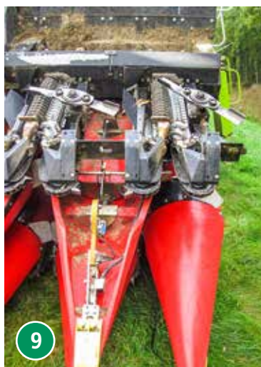
Prototyp des Maispflückers der Firma Geringhoff mit nach vorn versetztem Unterflurhäcksler und Schlagleisten an den Messern (li.) und die auf der Agritechnica vorgestellte Serienausführung mit geteiltem Vorsatz zur besseren Boden Anpassung sowie weiterentwickeltem Unterflurhäcksler (r.) Foto r.: Werkbild
