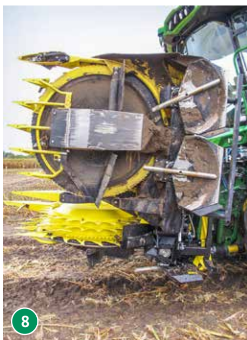
Beim Kemper StalkBuster passen sich die pendelnd aufgehängten Reihenaggregate optimal an die Bodenoberfläche an. Maisstengel werden zerstört, die Stoppelreste aufgefaser.
