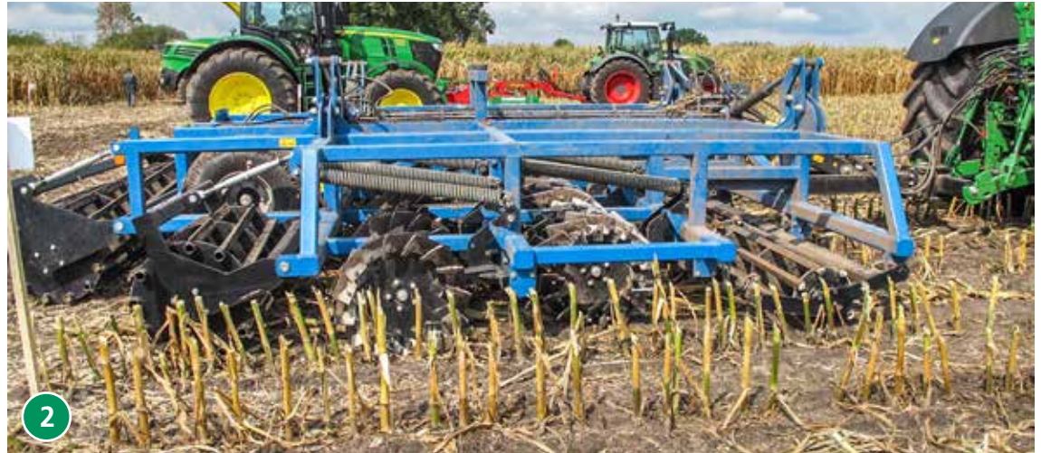
2 Die vorlaufende Stabwalze beim Hektor Gigant der Firma IAT zerquetscht die Stängel, die in zwei Reihen angeordneten Messerräder dahinter sind einzeln aufgehängt und greifen etwa 2 bis 3 cm tief in den Boden ein. Eine Rohrstabwalze sorgt für die Tiefenführung. Fotos (10): Dr. Norbert Uppenkamp
