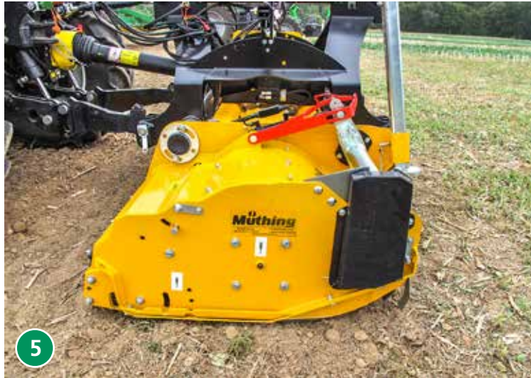
Das Besondere am Mühling MU Pro Vario ist die verstellbare Schneidschiene, mit der man sich an unterschiedliche Aufwüchse anpassen kann.
