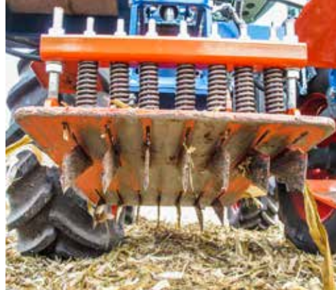
Aufbau (li.), Werkzeuganordnung (Mitte) und Arbeitsbild (r.) des Stoppelschlitzers der Firma TerraTec. Die Stoppeln werden von der Tiefenführungsplatte umgknickt und durch die Messer in Längsrichtung geschnitten.
