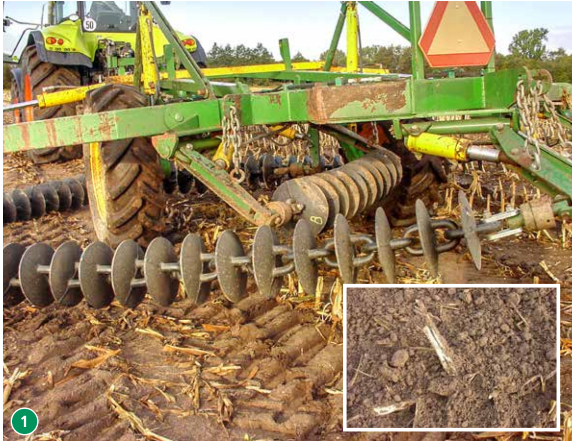
1 Aufbau (großes Bild) und Arbeitsbild (kleines Bild) der Kettenscheibenegge der Firma Kelly. Durch den steilen Anstellwinkel der Scheiben werden die Stoppeln „aufgerieben“.
