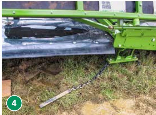
Beim Kreiselschläger der Firma Z-ex zerkleinern Rundstämme an Ketten die Maisstoppeln. Die Werkzeuge sind dadurch unempfindlich gegen Steine, und eine sehr flache Bodenbearbeitung ist möglich.
