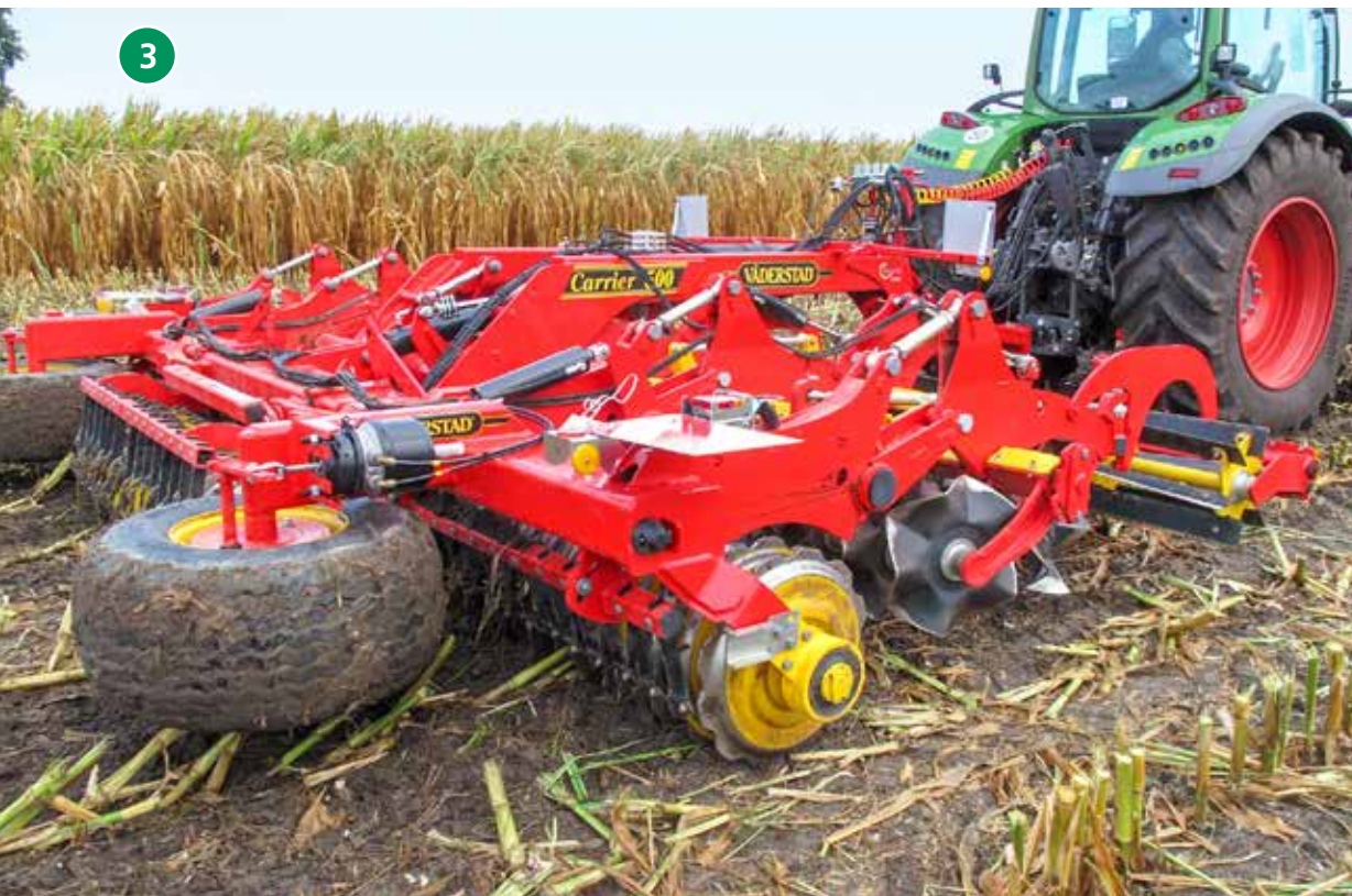
3 Die Väderstad Carrier CrossCutter Disk ist eine Kombination aus Schneidwalze, stark gewellten Schneidscheiben und Walze.
