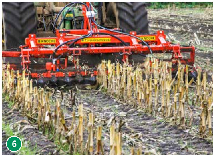
Zünslerschreck Aktiv der Firma Knoche. Die Stoppeln werden zwischen den hydraulisch angetriebenen Rotoren und einer Gegenplatte verdreht und gerieben. Foto: Werkbild
