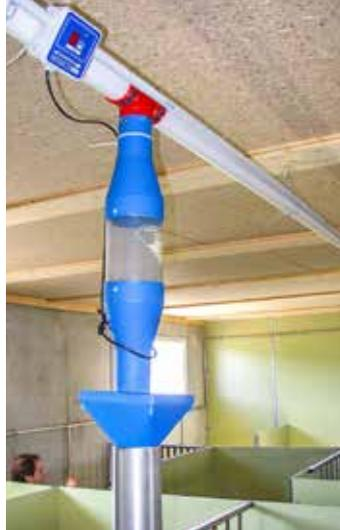
Die Tecnofeed-Fütterungseinheit von Globogal, mit der am Futterrohr angebrachten Zählleinheit
