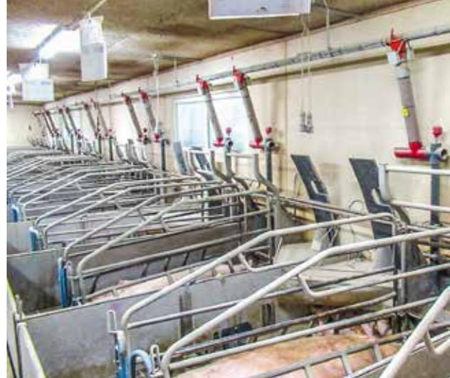
Fütterungstechnik von Schauer: eine MamaDos-Anlage mit dem Querantrieb zum Futterfallrohr in den Trog
