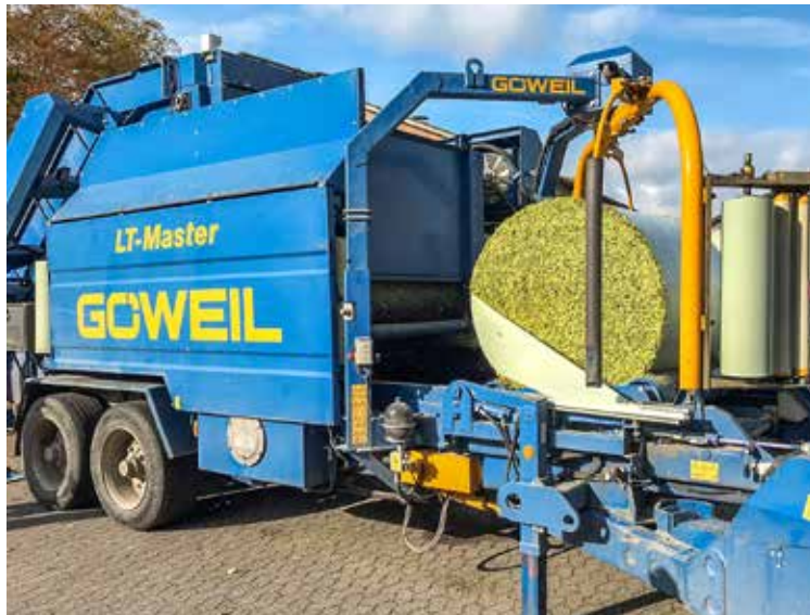
Bei der LT Master von Göweil gleitet der fahrbare Wickeltisch unter die Presse und übernimmt den mit vier Lagen Mantelfolie umwickelten Ballen. Während in der Kammer schon der nächste Ballen gepresst wird, sorgt der Doppelwickelarm für das Einstretchen des Ballens. Fotos: Dr. Susanne Ohl
