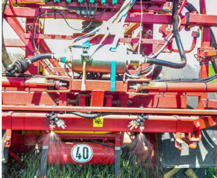
Das System „agro-kat“ wird in der Feldspritze in den Flüssigkeitsstrom zu den Teilbreiten eingebaut und soll das Wasser vitalisieren, indem dessen Moleküle ausgerichtet werden.
