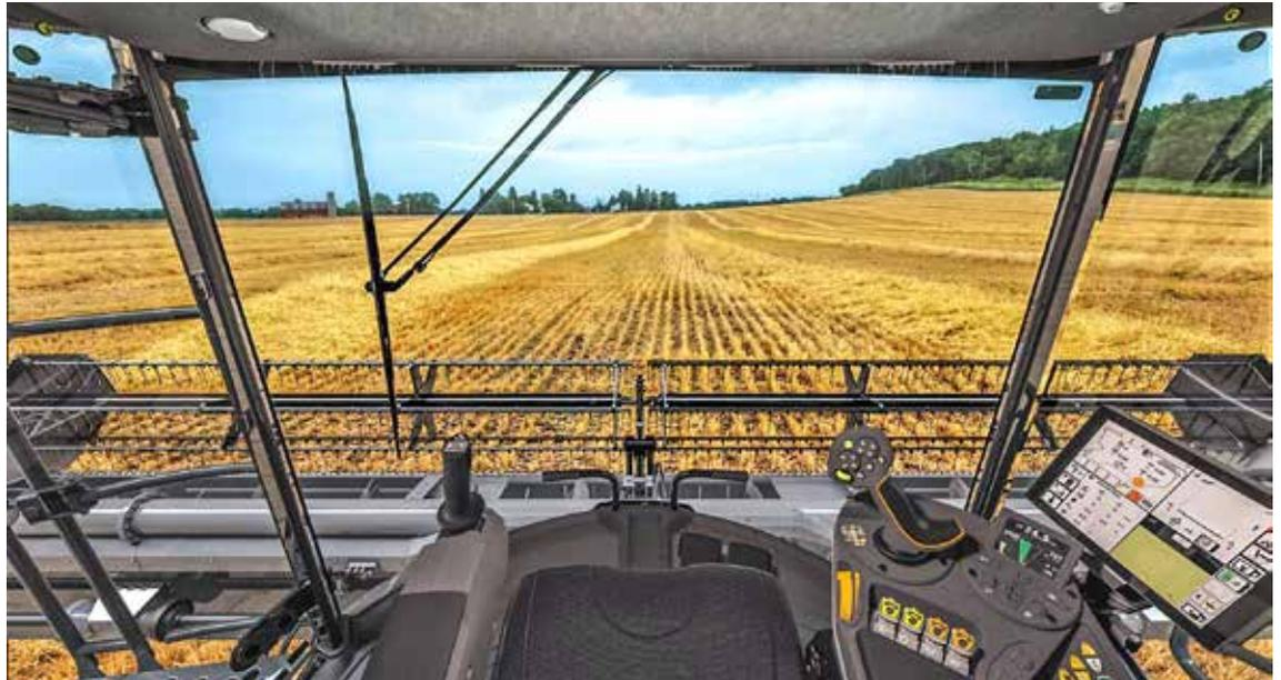
Während der Druschfruchternte beeinträchtigen das Lenkrad und die Lenksäule die Sicht auf den Einzug des Erntegutes direkt vor dem Schrägförderer. Dies gilt speziell unter schwierigen Bedingungen. Durch den Verzicht auf Lenksäule und Lenkrad schafft man freie Sicht auf den Bereich direkt vor dem Drescher. Foto: Werkbild
