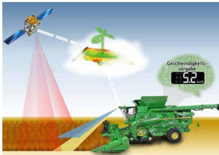
Durchsatzregler von Mähdreschern können erst auf Änderungen des Erntegutes reagieren, wenn sich das Material bereits im Erntevorsatz, im Einzugskanal oder im Dreschwerk befindet. Durch eine vorausschauende Durchsatzregelung mit 3-D-Stereokameras, die die Bestandssituation vor dem Drescher erkennen, und einem vorausschauenden Fahrer kann das Problem gelöst werden.
