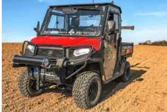
Das Sensorfahrzeug mit geoTouch SoilOptix liefert eine hochauflösende Oberbodenkartierung mit nur einer Feldüberfahrt. Fotos: geo-konzept
