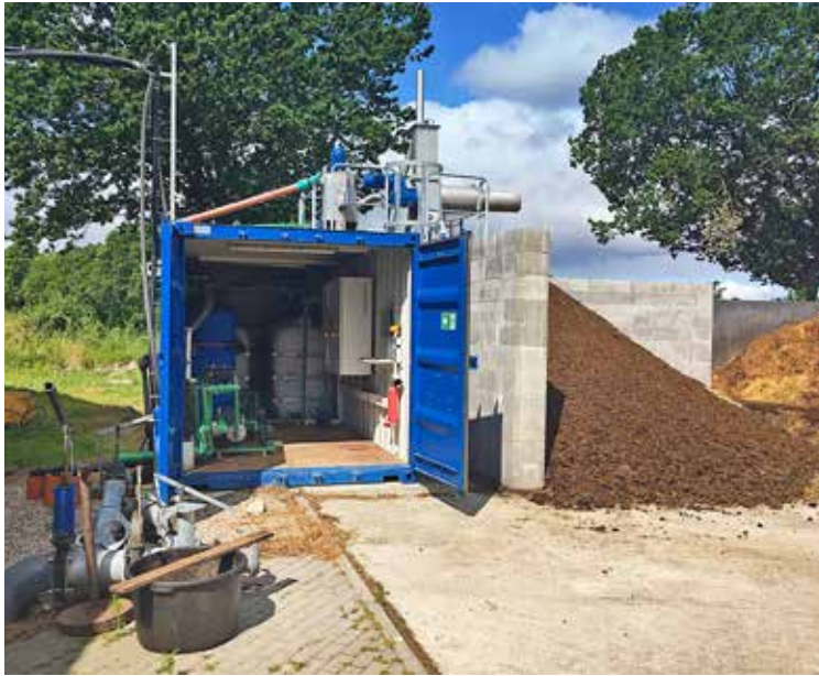
Der Separator trennt das Gülle-Mist-Gemisch in eine feste (r.) und eine flüssige Phase (Lagercontainer li.). Foto: Benjamin Wrobbel
