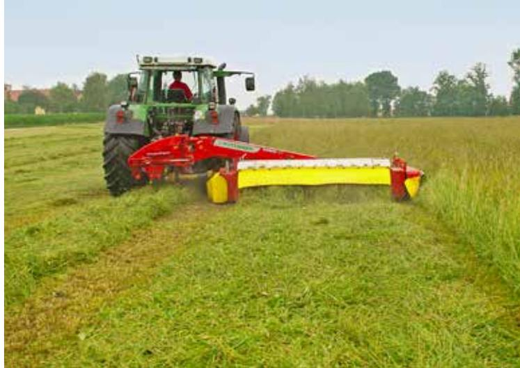
Die Lösung für den Einzelbetrieb: Scheibenmähwerk mit integriertem Aufbereiter und Breitablage des Futters zum besseren Anwelken
