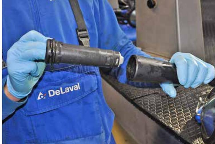
Melkzeug mit Kartuschensystem zum schnellen Zitzengummiwechsel
