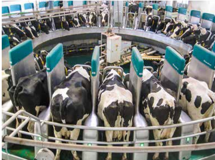
Das Melkkarussell Dairy von GEA: Jeder Melkplatz ist mit einem eigenen Einzelbox-Melkroboter bestückt.
