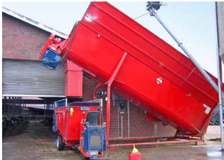
Automatische Befüllung über Vorratsbehälter
