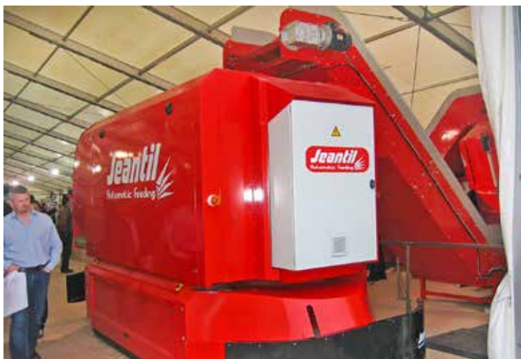
Einsatz eines Förderbandes zur Beschickung eines autonomen, batteriebetriebenen Futterverteilers
