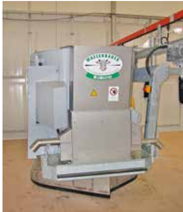
Futtermisch- und Verteilwagen mit Nachschieb- und Lockfutterfunktion
