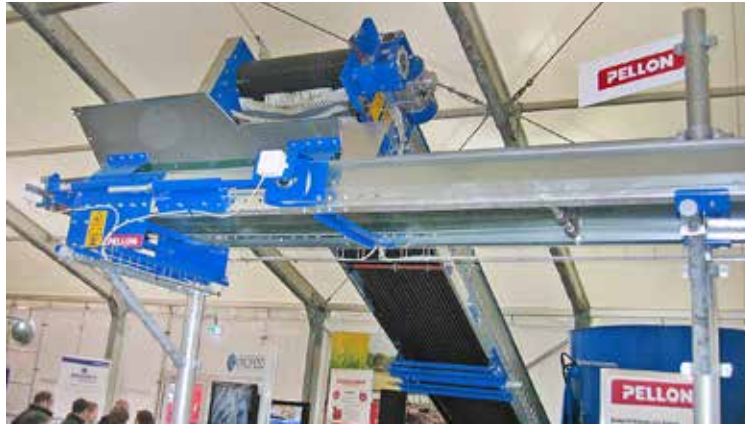
Bei Einsatz von Bandfütterungssystemen werden nur Futtertischbreiten von 1,5 bis 2 m benötigt.
