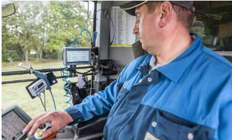
Fahrer Frank Schröter kann während des Drusches die Anzeige des Condition Levels der beiden mit Sensoren ausgestatteten Riemen beobachten.
