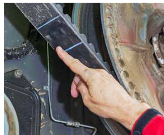
Im markierten Bereich auf dem Breitkeilriemen (hier für den Dreschtrommelantrieb) ist ein Sensor einvulkanisiert.
