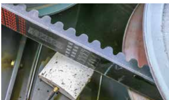
Breitkeilriemen mit Sensor und dazugehöriger Antenne für den Rotorantrieb des Lexion 780
