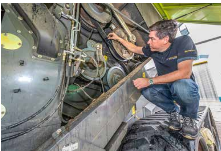
Thorsten Schwefe am Breitkeilriemen im Variator für den Antrieb der Dreschtrommel des Lexion 780 Fotos: Werkbilder
