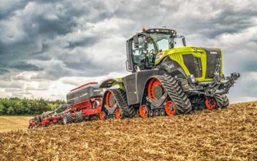
*Claas Xerion mit 500 PS und Dreiecksraupen von Zuidberg und Camso. Bei 24 t Gewicht mit mindestens um ein Viertel größerer Bodenkontaktfläche werden mit weniger Schlupf enorme Zugkräfte im Boden abgestützt. Aus echter Vorfahrt und der Zugkraft ergibt sich die Zugleistung. Hohe Zugleistung bringt hohe Flächenleistung. Durch halbierten Schlupf im Vergleich zum Reifenfahrzeug kann der Dieserverbrauch pro Hektar niedriger sein. Auf der Straße ist der Dieserverbrauch deutlich höher.*
