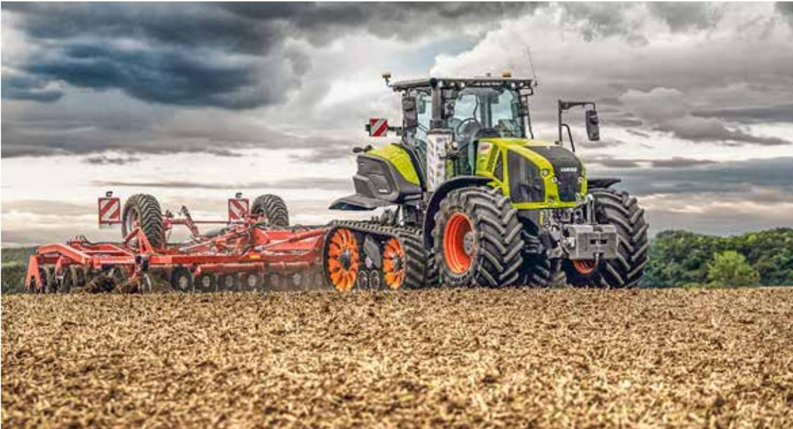
Gezogene Bodenbearbeitung auf Großbetrieben und Bodensanierung mit hohen Zugleistungsanforderungen sind die Felder für den Claas Axion Terra Trac. Für mehr Zugkraft, Federung, 40 km/h Straßengeschwindigkeit, Niveauregelung und Lenkunterstützung durch Abbremsen der kurveninneren Halbraupe werden zusätzlich 85.000 € aufgerufen. Keine Überbreite auf der Straße, weniger Schlupf, mehr Flächenleistung, komfortables Fahren im Acker sind die Pluspunkte.
