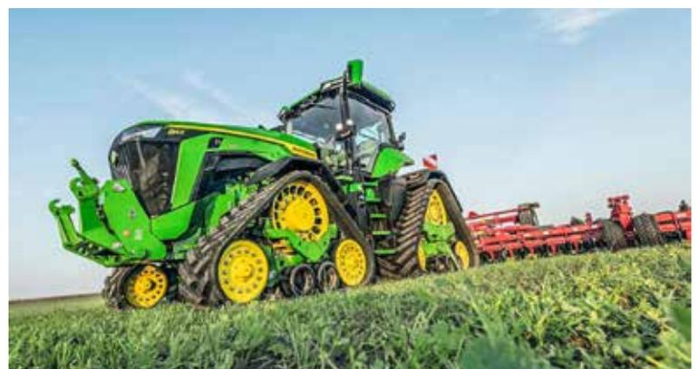
Mit den 4-Dreiecksraupen gewinnt die John Deere Raupe 8RX mehr Zugleistung, Wendigkeit, Selbstreinigung der Profile im klebrigen Boden, besseren Geradeauslauf am Seitenhang und vermeidet die Erdwälle beim Kurvenfahren. Bei 65.000 € Aufpreis ist der Unternehmer gefordert: Können mit innovativer Technik die Herstellkosten für meine Ackerfrüchte gesenkt werden?
