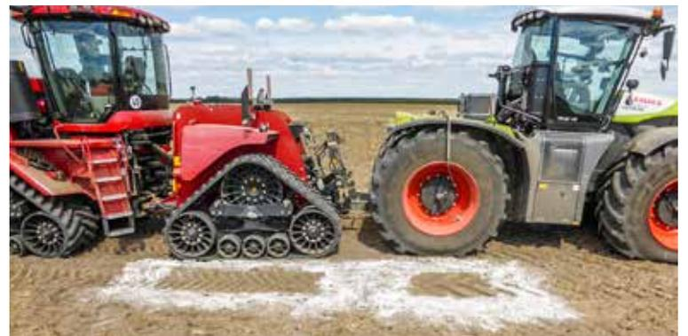
*Richtiger Reifendruck und richtige Ballastierung verbessern den Wirkungsgrad beim Traktoreinsatz. Die Bodenkontaktfläche der Raupe ist deutlich größer im Vergleich zum Reifen. Es werden Schlupf und Spurtiefe vermindert und Schadverdichtungen eher vermieden.*
