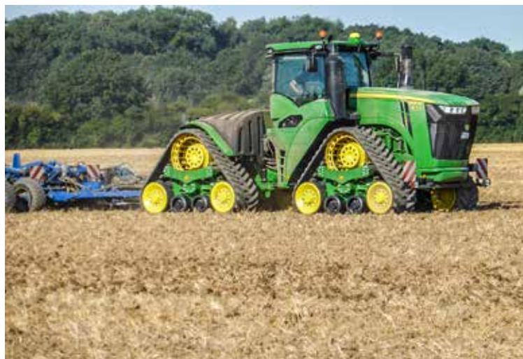
Trotz des hohen Gewichts des Traktors entspricht der Bodendruck zirka 1 bar, ein guter Wert für besseren Bodenschutz und gleichmäßiges Pflanzenwachstum.
