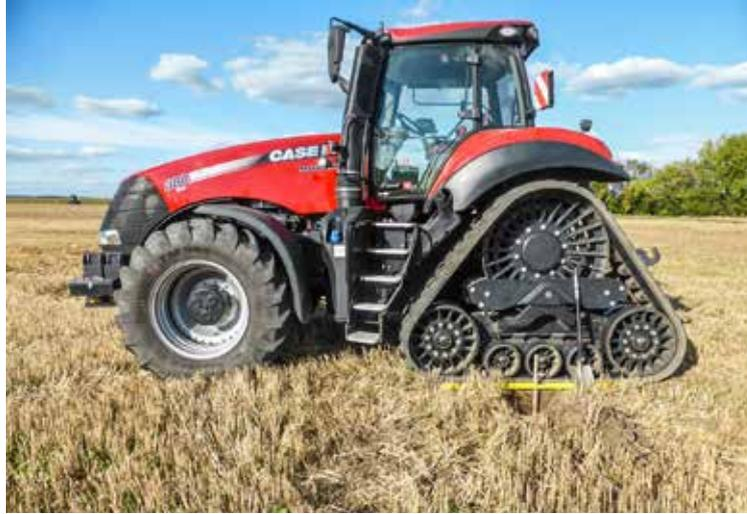
Case Magnum mit Raupen auf der Hinterachse und Reifen auf der Lenkachse. Für schwere Zugarbeiten in der Bodenbearbeitung übernimmt die Dreiecksraupe zirka 80 % der Zugarbeit. Die deutlich höheren Kosten von plus 60.000 €, die Erschütterungen für Fahrer und Traktor durch das fehlende Luftkissen des Reifens und die eingeschränkte Straßentauglichkeit werden von Praktikern als Argument gegen die Halbraupe genannt.
