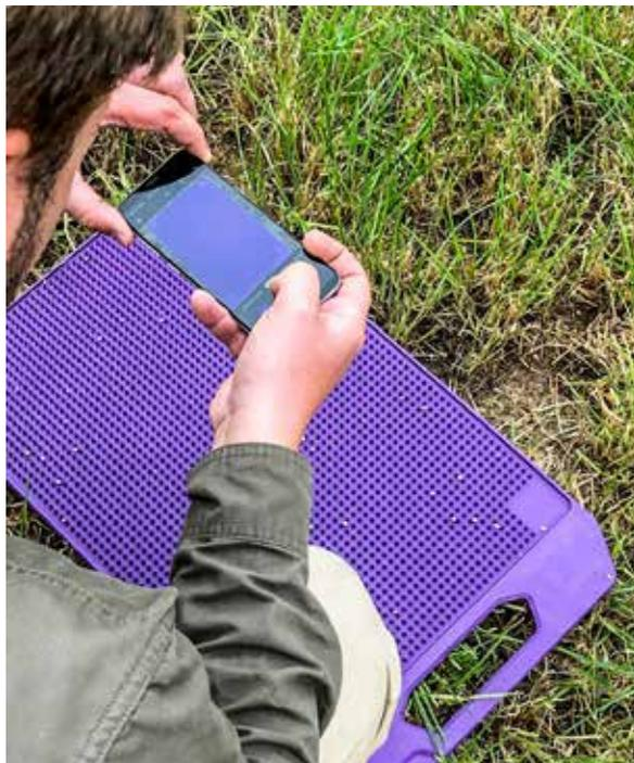
Der Dünger wird unter Einsatzbedingungen von solchen Matten aufgefangen und per Smartphone-Bildauswertung eingestuft. Foto: Hochschule Osnabrück
