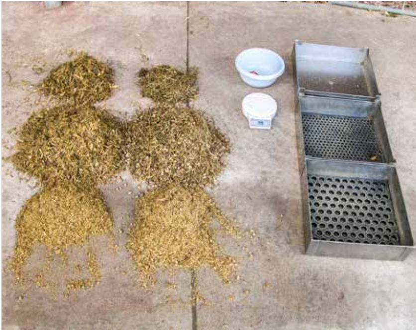
Wie homogen vorgelegte Rationen wirklich sind, lässt sich mittels der Schüttelbox schnell und leicht nachweisen. Fotos: Prof. Katrin Mahlkow-Nerge
