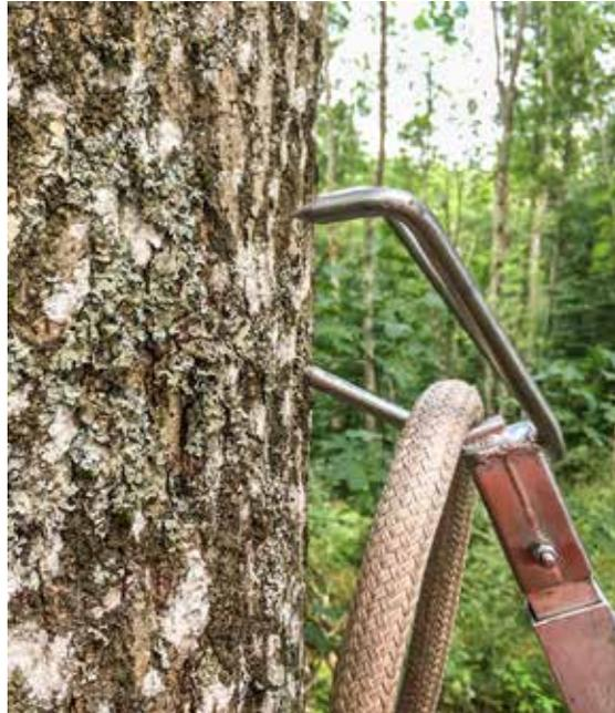
Mit einer Tothholzkralle wird das Seil am Baum angestellt. Beim Anziehen kann so der Gefahrenbereich verlassen werden. Fotos: SVLFG
