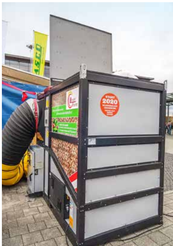
Warmfluterzeuger, befeuert mit Holzhackschnitteln
