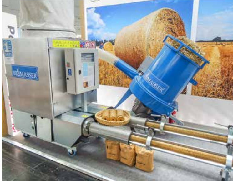
Strohbrickettieranlage als Doppelstrangpresse
