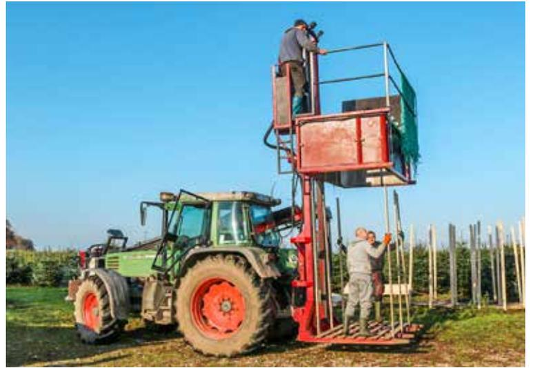
Die Spezialmaschine hinter dem Schlepper netzt die einzelnen Bäume ein. Nach diesem Arbeitsschritt werden sie für den Weitertransport von der Fläche zum Verkauf auf Paletten gestapelt.
