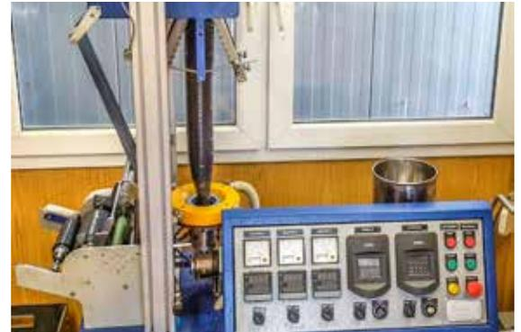
Folienblasanlage im Labor zur Sicherstellung der hohen Qualitätsanforderungen an das Regranulat
