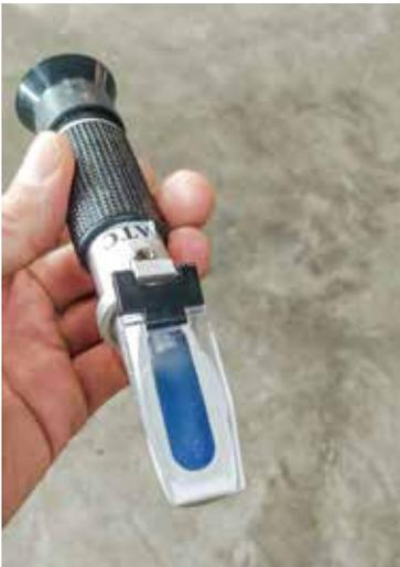
Die Qualität der Biestmilch kann schnell und einfach mittels eines Handrefraktometers mit Brix-Skala bestimmt werden. Einfache Modelle können preiswert über das Internet bezogen werden.
