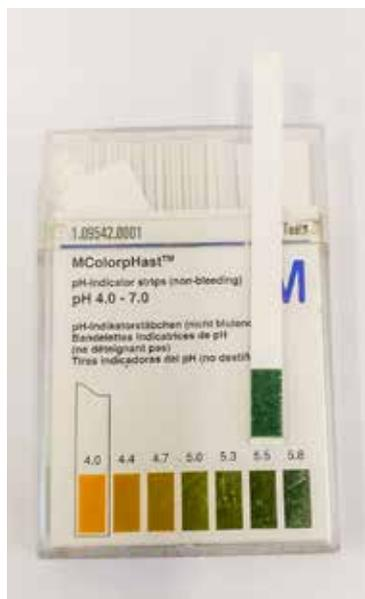
Die Ansäuerung der Kälbermilch kann leicht mittels pH-Teststreifen aus der Apotheke oder einem Internetkaufhaus überprüft werden. Mit der zugesetzten Säuremenge sollte ein pH-Wert von 5,5 erreicht werden.
