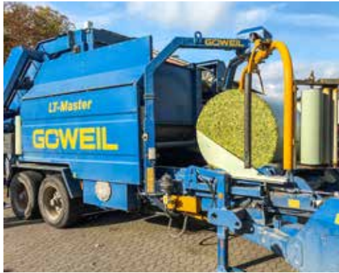
Der fahrbare Wickeltisch gleitet unter die Presse und übernimmt den mit vier Lagen Mantelfolie umwickelten Ballen. Während in der Kammer schon der nächste Ballen gepresst wird, sorgt der Doppelwickelarm für das Einstretchen des Ballens. Die während der Vorführung erzeugten Ballen wogen im Mittel 840 kg bei einem TM-Gehalt von 35 %.
