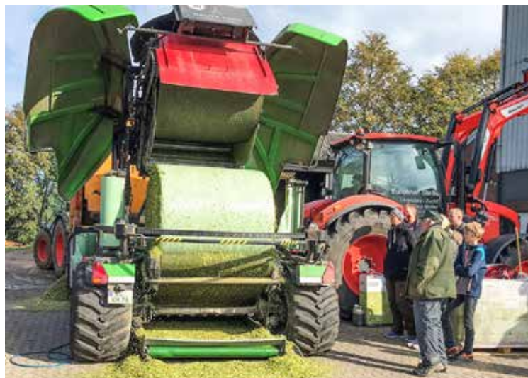
Der Multi-Press-Vorsatz verwandelt eine herkömmliche I-Bio-Press-Wickel-Kombination von Kuhn in eine Maisballenpresse. Nach dem Pressen öffnet sich die Kammer und der ummantelte Ballen wird mit Stretchfolie umwickelt. Die während der Vorführung erzeugten Ballen wogen im Mittel 1.005 kg bei 35 % TM-Gehalt.
