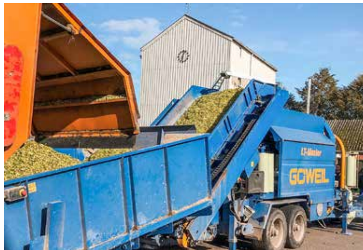
Das Häckselgut wird bei der LT Master von Göweil direkt in den Zubringer abgekippt und über den Steilförderer in die Presskammer gebracht.
