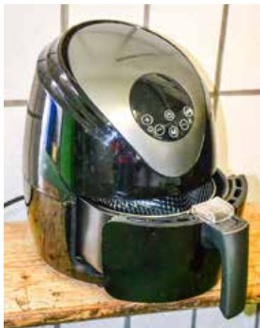
Heißluftfritteuse zur TS-Bestimmung der TMR-Proben
