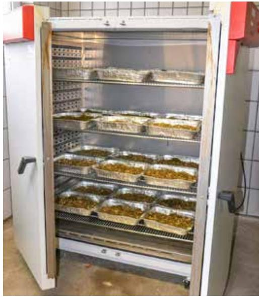
Trockensubstanzbestimmung der TMR-Proben mittels Trocknungsschrank
