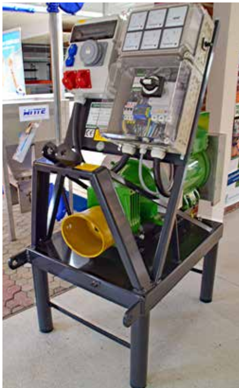
Schlepperbetriebenes mobiles Notstromaggregat
