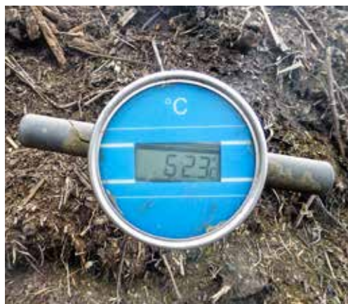
Durch Mietentemperaturen bis 70 °C werden RAL-zertifizierte Komposte weitgehend hygienisiert.
