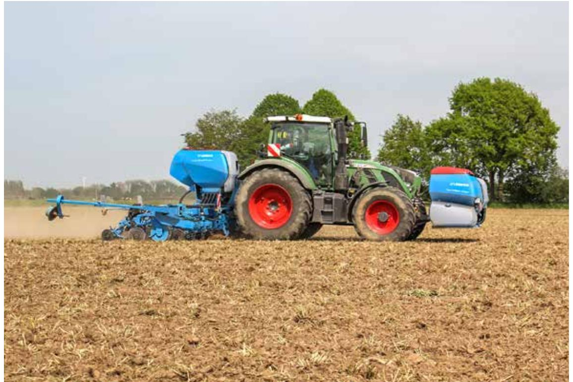
Mit dem Frontbehälter Solitär 23 erweitert Lemken sein Programm der pneumatischen Sätechnik. Der Behälter für Saatgut oder Dünger ist, kombiniert mit verschiedenen Geräten, vielfältig einsetzbar. Fotos: Werkbilder
