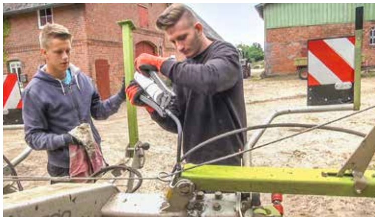
Benjamin Möckelmann und Pascal Pretzer (v. li.) haben auf dem Betrieb Wulf vieles gelernt. Hier geht es ums richtige Abschmieren vor dem Maschineneinsatz. Foto: Sabine Sommerschuh
