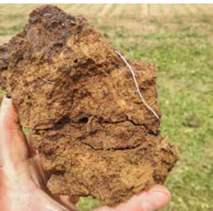
Die horizontalen Bruchlinien deuten auf die beginnende Ausbildung eines sogenannten Plattengefüges hin – ein Anzeichen für bewirtschaftungsbedingte Bodenverdichtung.
