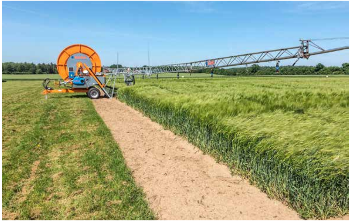
Mobile Beregnungsanlage mit Düsenwagen
