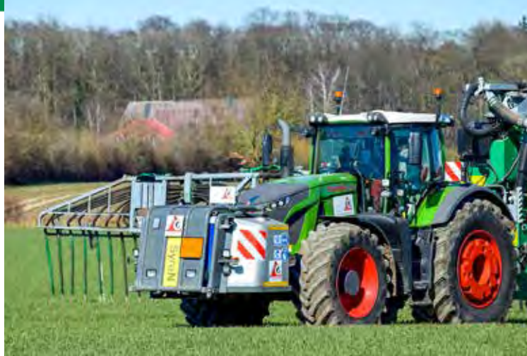
Durch die Zugabe von Schwefelsäure zur Gülle können Ammoniakemissionen minimiert werden. Fotos: Lea-Sophie Steffensen
