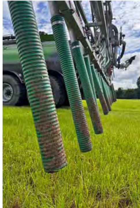
Eine streifenförmige Aufbringung ist notwendig für eine effiziente Ausnutzung des Stickstoffs aus der Gülle. Sie ist seit Februar 2025 verpflichtend einzusetzen.
