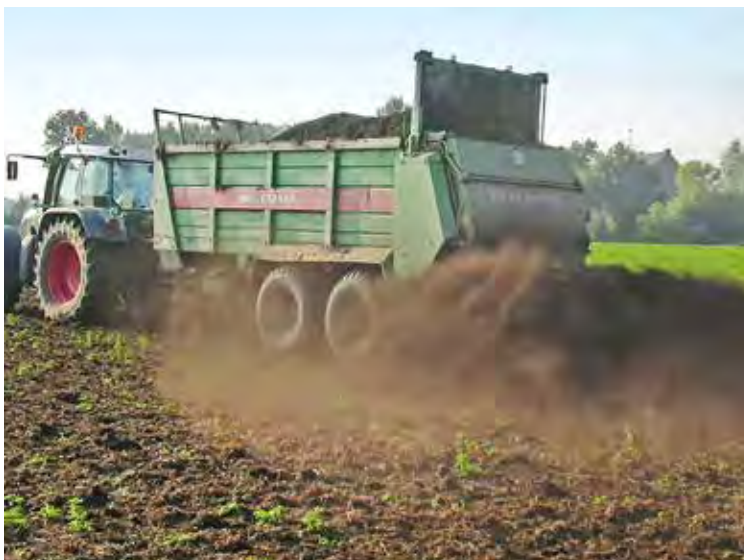
Auch bei der Kompostausbringung ist auf eine gute Längs- und Querverteilung zu achten. Fotos (2): Peter Lausen
