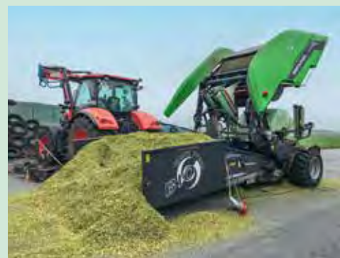
(Teil-)stationäre Ballenpressen für Mais verwenden Mantelfolie statt Netz. Der sofortige Luftabschluss gibt Hefen und Schimmelpilzen keine Zeit für Vermehrung und minimiert dadurch die TM-Verluste erheblich.
