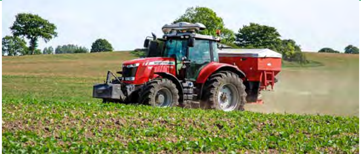
Sensoren an Düngerstreuern können während der Überfahrt den Chlorophyllgehalt und die Biomasse des Bestands messen und die Düngermenge automatisch anpassen. Foto: Hanna Makowski
