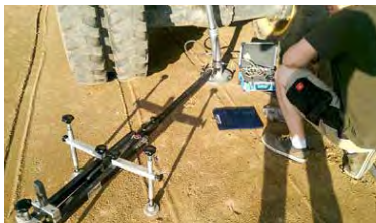
Die Überprüfung durch Lastplattendruckversuch schafft Investitionssicherheit.
