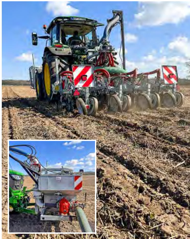
Über den Domdeckel wird Kieserit fein kurz vor der Ausbringung in die Gülle eingemischt (kleines Foto). Durch die gezielte Applikation der Gülle oder des Gärrestes mit Einmischung von Kieserit fein in ein Bodendepotband werden insbesondere umweltrelevante Nährstoffe wie N und P vor Verlusten und Austrägen in sensible Gewässer geschützt. Fotos (2): Hanna Makowski
