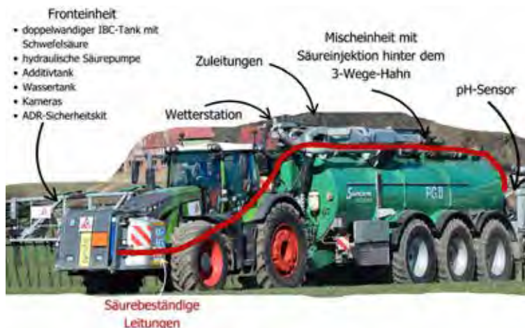
Abbildung 3: Aufbau des SyreN-Systems
